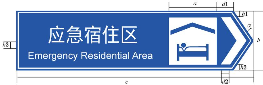
图中  $a$  为避难场所功能区图形符号边长尺寸,  $b = 1.2a$ ,  $c = 5a$ ,  $d1 = 0.3a$ ,  $d2 = 0.15a$ ,  $h1 = h2 = 0.1a$ ,  $h3 = 0.1a$ ,  $\alpha = 30^\circ$ 。
