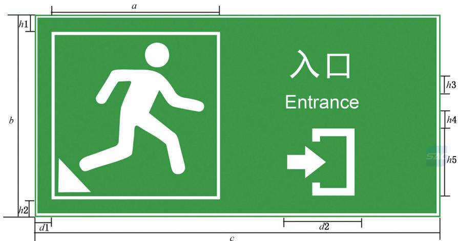
图中  $a$  为室外型避难场所图形符号边长尺寸,  $b = 1.2a$ ,  $c = 2.4a$ ,  $d1 = 0.1a$ ,  $d2 = 0.4a$ ,  $h1 = h2 = h3 = h4 = 0.1a$ ,  $h5 = 0.4a$ 。
