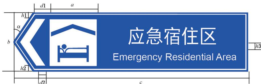
图中  $a$  为避难场所功能区图形符号边长尺寸,  $b = 1.2a$ ,  $c = 5a$ ,  $d1 = 0.3a$ ,  $d2 = 0.15a$ ,  $h1 = h2 = 0.1a$ ,  $h3 = 0.1a$ ,  $\alpha = 30^\circ$ 。
